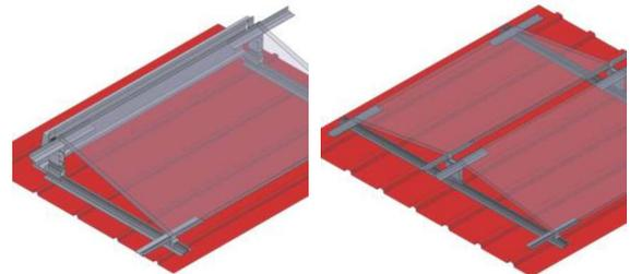
TYP QUER (Bodenprofil quer zur Sicke)
