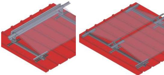
TYP PARALLEL (Bodenprofil parallel zur Sicke)
